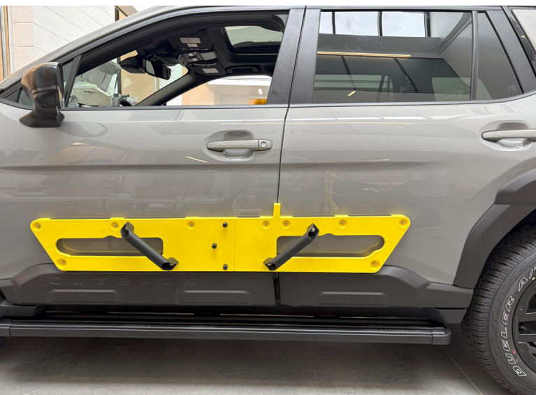
この図は、FDM製の治工具を使って車体側面のモールディングを取り付ける位置を正しく決める方法を示しています。
