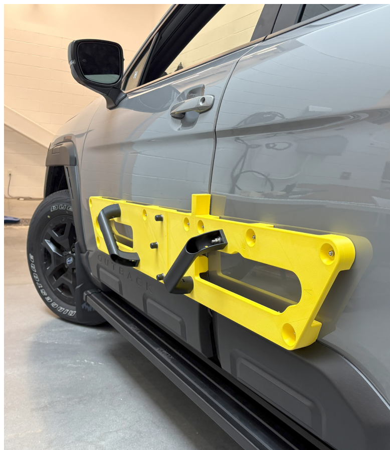
磁石で治工具が車に密着します。造形後に治工具に接着されたソフトタッチパッドは表面の傷を防ぎます。
