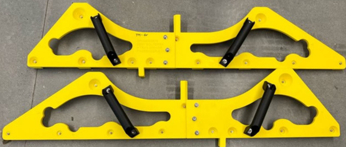
位置決め固定具は高可視性の黄色ASA材料で造形されていました。ハンドルは標準的な市販のストックです。
