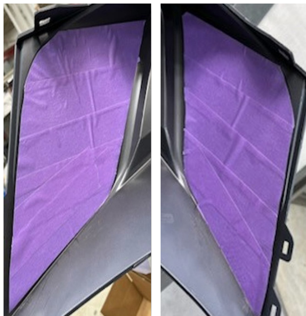
3Dプリントされた塗装用マスクに貼られたテープにより、マスキングの効果をチェックします。
