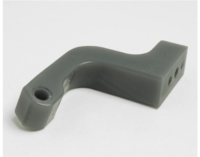
Origin One の Loctite ® 3D 3172 resin で造形された 3D プリンタのメインブラケット
