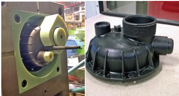
金型用インサート（左）および射出成形した最終部品（右）。
