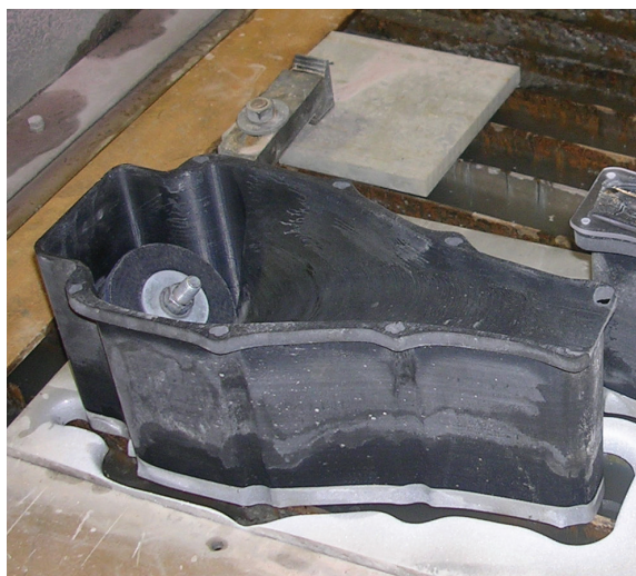
NASCAR社のトップチームであるJoe Gibbs Racingでは、2年以上利用してきたものもある固定具をFDMを使って製作し、リードタイムとコストを平均70%削減。
