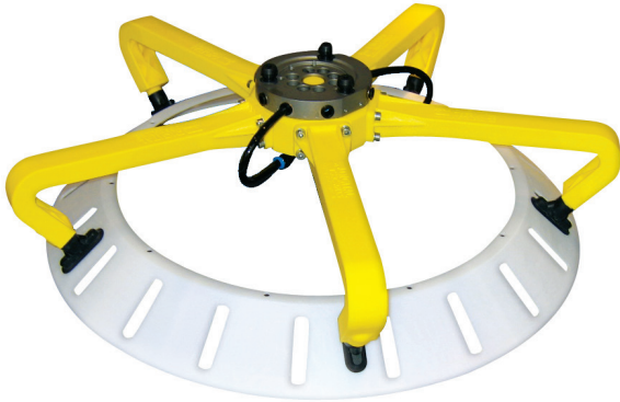
Digital Mechanics社では、アディティブ・マニファクチャリングによってグripperを真空チャンネル内蔵型に作り直すことで、作業の邪魔になっていた5本のホースが除去された。
