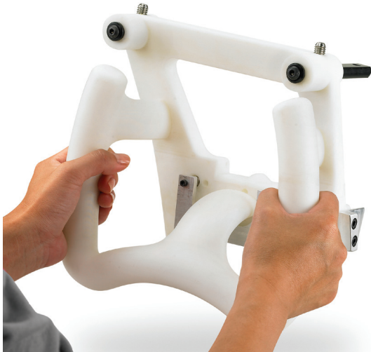
BMW社では、FDMを使って従来のマシニング加工および製作方法では対応できなかった治具や固定具の造形を行っている。AMがより使いやすく、機能性が高いツールの造形を可能にしている。
